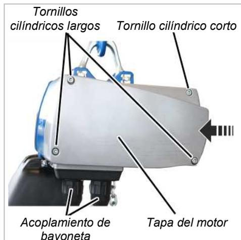
➔ Sujetar la tapa de motor en la carcasa.
