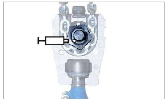
Engrase in situ/de fábrica con "Klüber Staburags NBU 12 Alltemp" referencia ABUS AN 14980.
