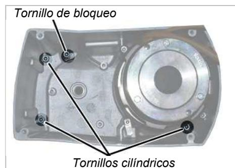
➔ Extraer los tornillos cilíndricos (3x)
